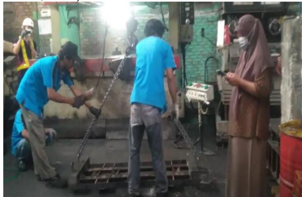
**Gambar 5** Penggunaan sarung tangan sebelum mengangkat roller dies
