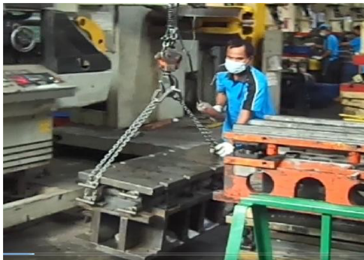
Gambar 4. Implementasi SMED pada Pergantian Dies (Sumber : Dokumen Pribadi)
