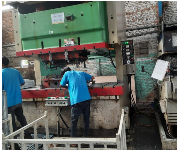
Gambar 1. Proses Pergantian Dies pada Mesin Press SEYI SN2-300 (Sumber : Dokumen Pribadi)
