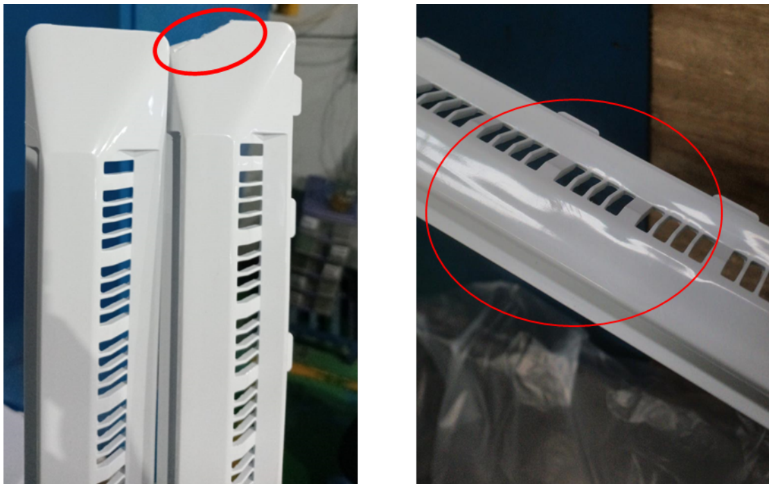
Gambar 1. Contoh Produk No Good (NG) pada Guide Duct PP Super White
