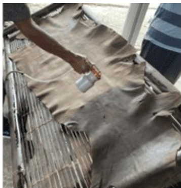
Gambar 4 Staining dengan metode spray
