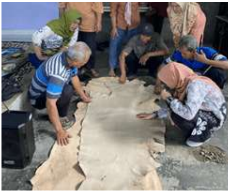
Gambar 2 Sortasi kulit crust untuk finishing pull-up
