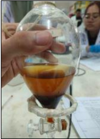
Gambar 4 Lapisan biodiesel atas metil ester dan bawah gliserol
