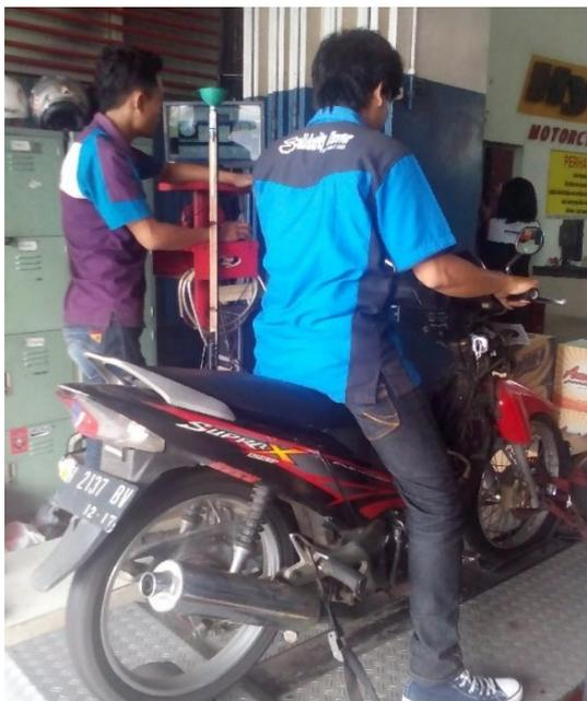
Gambar 3. Proses pengujian performa dengan *dynamometer*
