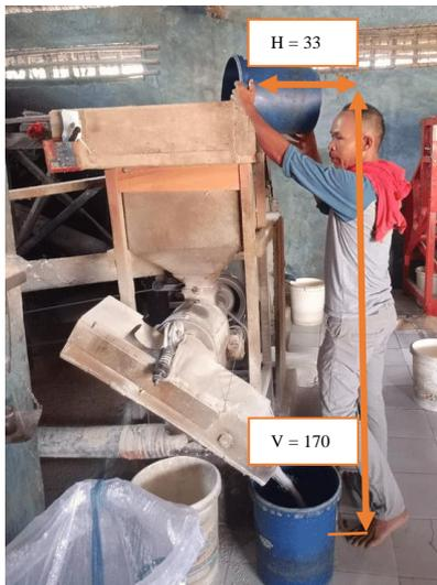
Gambar 8. Posisi Akhir Aktivitas Penuangan Beras Pecah Kulit Ke Mesin Penyosoh
